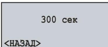
Рисунок 7.8.7 – Экран настройки таймаута подключения к Web-серверу
